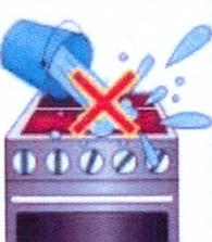
Не охлаждай нагретую поверхность плиты, сковороды или другого теплового оборудования водой.
